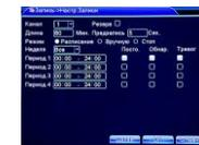
«Канал» Выберите номер канала, чтобы начать с ним работу. Выберите «все», чтобы работать со всеми каналами.
